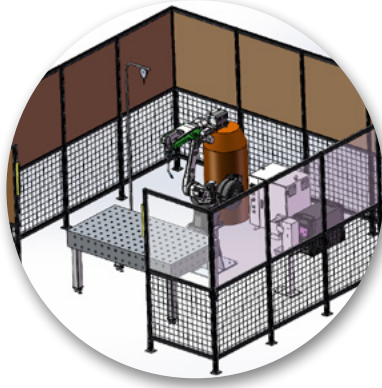
Роботизированная сварочная ячейка с стационарным сварочным столом
