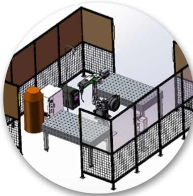
Роботизированная сварочная ячейка с двумя стационарными сварочными столами
