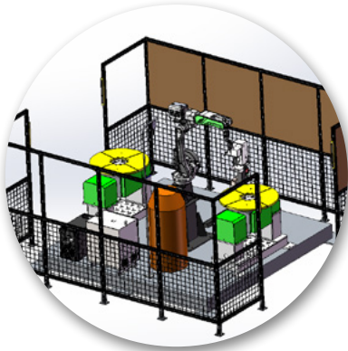
Роботизированная сварочная ячейка с двумя двухосевыми позиционерами
