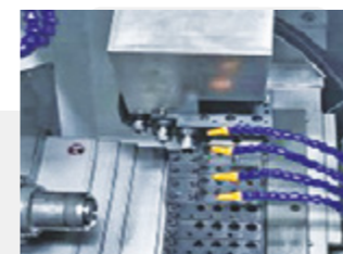
Без задней бабки с инструментальным столом и приводным блоком
